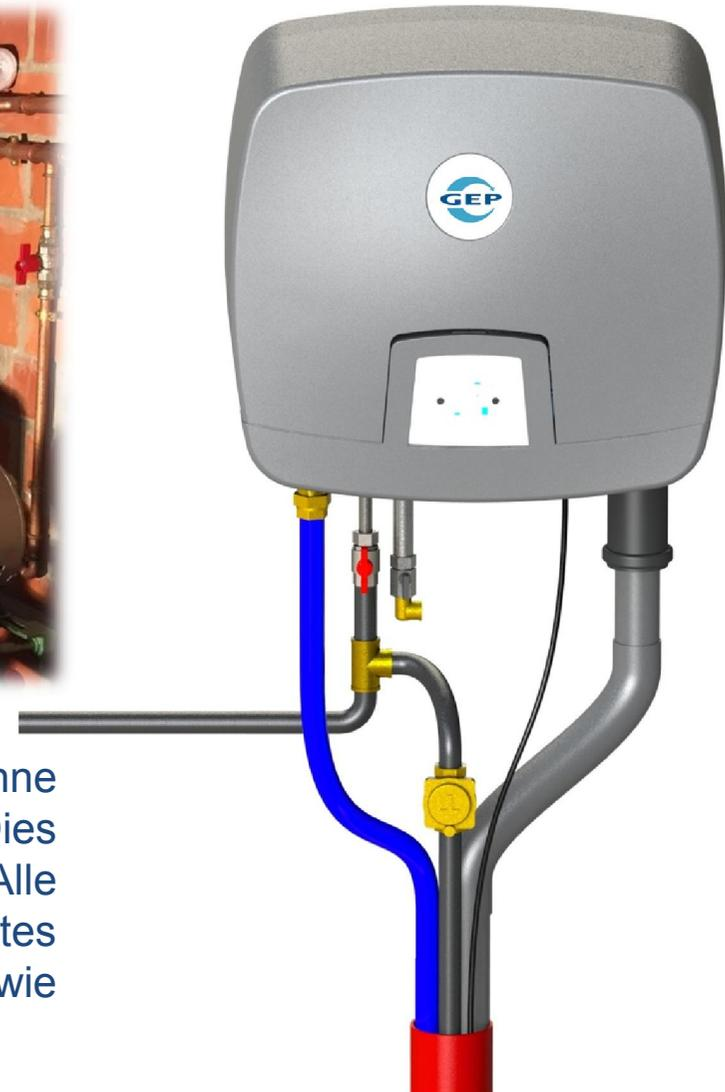
Der IRM-Wassermanager (auf diesem Foto ohne Schaumhaube) ist auf einer massiven Wand befestigt. Dies reduziert die Übertragungsgeräusche zum Haus. Alle Anschlüsse befinden sich an der Unterseite des Gerätes und sind mit flexiblen Verbindungselementen sowie Überwürfen zur einfachen Montage versehen.
