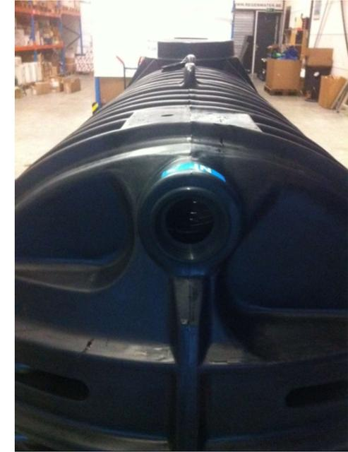
Kunststoff Tank für häusliches Abwasser. Der Tank wird vormontiert geliefert.
