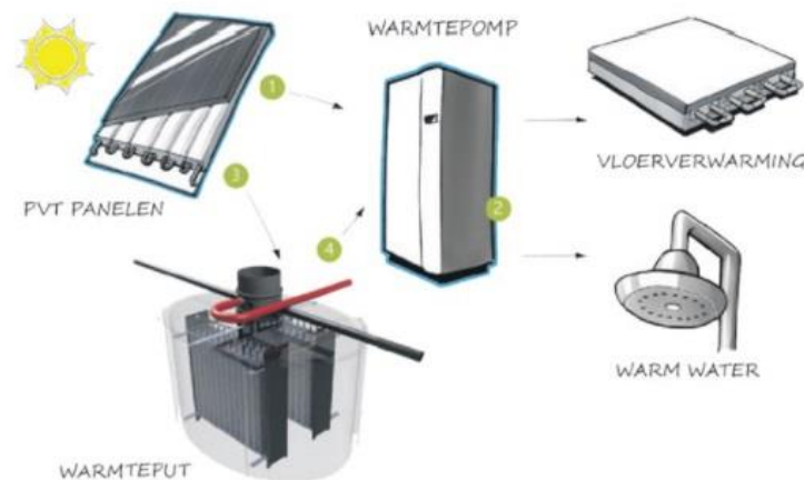
Principe van regenwatersysteem met warmtepuit.
