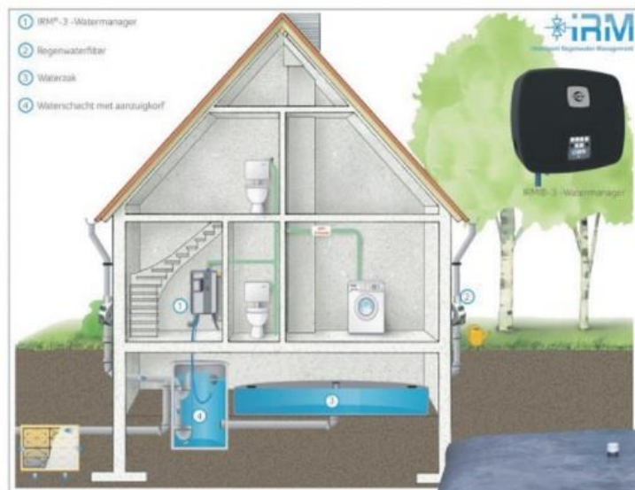
Regenwatersysteem met waterzak in de kruipruimte.
