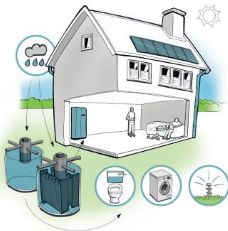
Das 2-Zisternen-System ermöglicht die Regenwassernutzung in Haus und Garten unabhängig von der thermischen Nutzung und bietet zusätzliches Retentionsvolumen.
